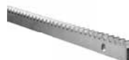
AJ91112/3 4 mt di cremagliera in acciaio trafilato C40, M4 (30x12) zincata e forata (oltre 600 Kg), completa di 12 perni distanziali € 24,00 (prezzo al mt.)
